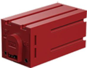
Der Encodermotor hat die gleichen Funktionen wie ein normaler Motor, bietet aber zusätzlich die Möglichkeit, die Umdrehungen zu zählen und mehrere Motoren synchron anzusteuern. Eine Umdrehung wird dabei in ~64 Schritte unterteilt.
