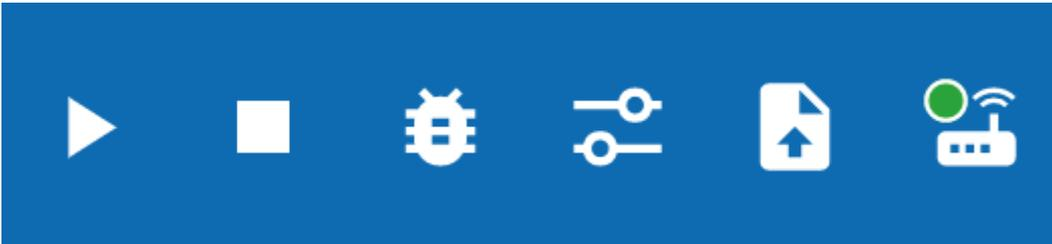
In der Kopfzeile befinden sich (v.l.n.r.) die Bedienungselemente für das Starten des Programms, das Stoppen des Programms, das Starten des Debugger, den Aufruf des Schnittstellentests, das Hochladen des aktuellen Programms und das Verbinden mit dem Controller.
