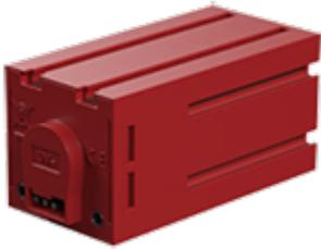
Der Encodermotor kann als Zähler eingesetzt werden. Gezählt wird die Anzahl seiner Umdrehungen, und zwar nicht nur, wenn er sich selbst als Motor dreht, sondern auch, wenn er von außen mechanisch angetrieben wird.
