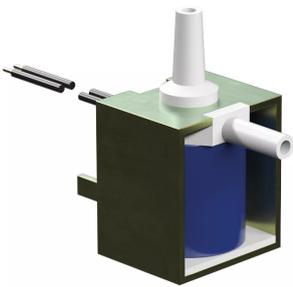
Ein Magnetventil ist wie ein elektrisch gesteuerter Wasserhahn. Statt ihn von Hand aufzudrehen oder zuzumachen, benutzt man Strom. Wenn Strom durch das Ventil fließt, aktiviert sich ein Magnet, der das Ventil öffnet oder schließt. So kann man den Fluss von Flüssigkeiten oder Gasen kontrollieren, ohne direkt am Ventil zu sein. Das ist praktisch für Systeme, die automatisch laufen sollen.
