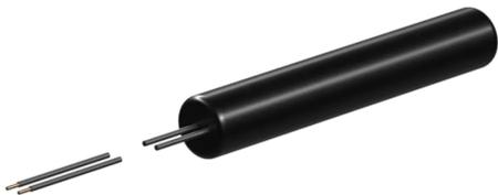
Der Reedkontakt ist ein magnetisch betätigter Schalter, der verwendet wird, um die Anwesenheit eines magnetischen Feldes zu erkennen. Der Kontakt schließt sich, wenn ein Magnet in der Nähe ist, und öffnet sich, wenn der Magnet entfernt wird.
