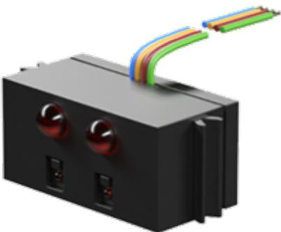
Der Infrarot-Spursensor ist ein digitaler Sensor zur Erkennung einer schwarzen Spur auf weißem Untergrund, der bei einem Abstand von 5 bis 30 mm von Sensor zu Untergrund arbeitet.
