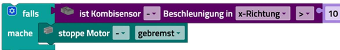
falls ist Kombisensor Beschleunigung in x-Richtung > 10 mache stoppe Motor gebremst
