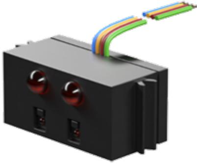
El sensor de seguimiento de infrarrojos es un sensor digital que detecta un rastro de color negro sobre un fondo blanco, y que funciona a una distancia de 5 a 30 mm del sensor al suelo.
