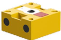
El fototransistor es un sensor digital que distingue entre claro y oscuro.
