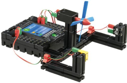
Un fototransistor se puede utilizar en una barrera fotoeléctrica como la del modelo.
