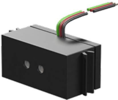
O sensor de cores envia luz vermelha e mede o quanto dela é refletida. Dependendo da intensidade do reflexo, o sensor de cores retorna valores de 0 a 2.000. É adequado para reconhecer cores previamente calibradas.
