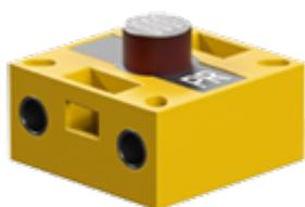
A resistência do fotorresistor diminuirá à medida que ele for exposto a mais luminosidade. O valor resultante do fotorresistor é, portanto, uma medida de luminosidade.
