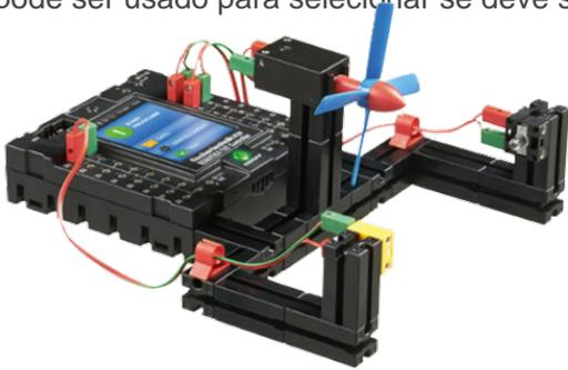
Um possível uso para um fototransistor é em uma barreira de luz,
