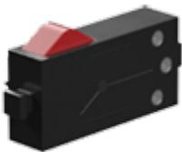
O teclado é um sensor digital que distingue "corrente fluindo" de "nenhuma corrente fluindo". Se a corrente flui ou não depende do cabeamento e se a tecla está pressionada. Você pode usar o teclado de duas maneiras diferentes:
