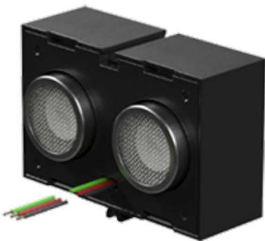
O sensor ultrassônico é usado para medir distâncias.
