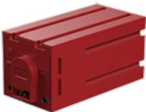
O motor codificador tem as mesmas funções de um motor normal, mas também oferece a opção de contar as rotações e controlar vários motores de maneira sincrônica. Uma revolução é dividida em ~64 etapas.
